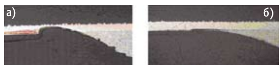
Рис. 1 Микрошлиф контактной площадки с растворенной медью. (а) Sn3,0Ag0,5Cu (б) ELSOLD TC07
